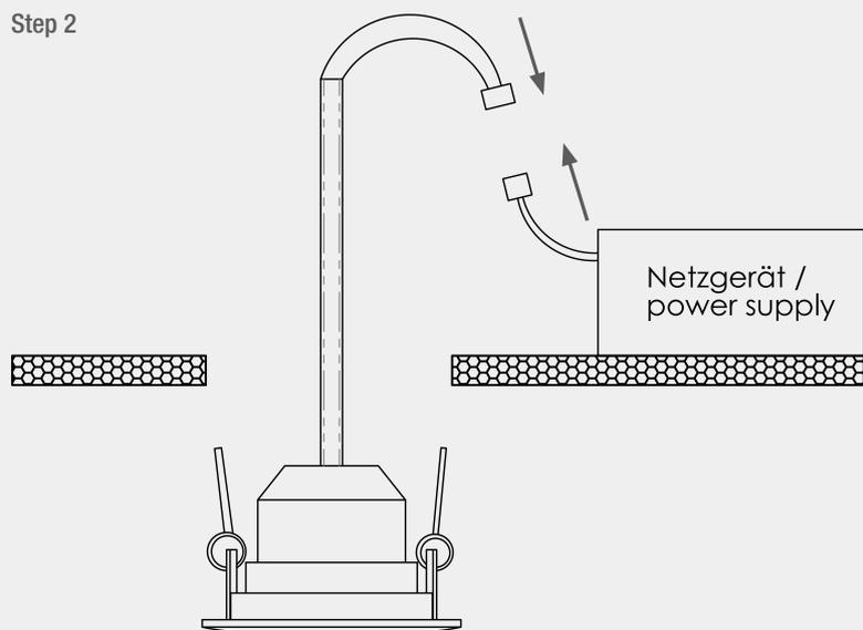
Leuchte immer im spannungslosen Zustand mit Konverter verbinden, LED kann sonst zerstört werden!
