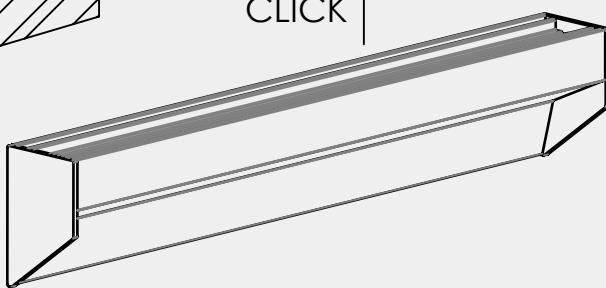
Lors du montage de l'agrafe, s'assurer qu'il est encore possible de la tourner un peu, sinon des craquements peuvent se produire en cas de dilatation thermique.
