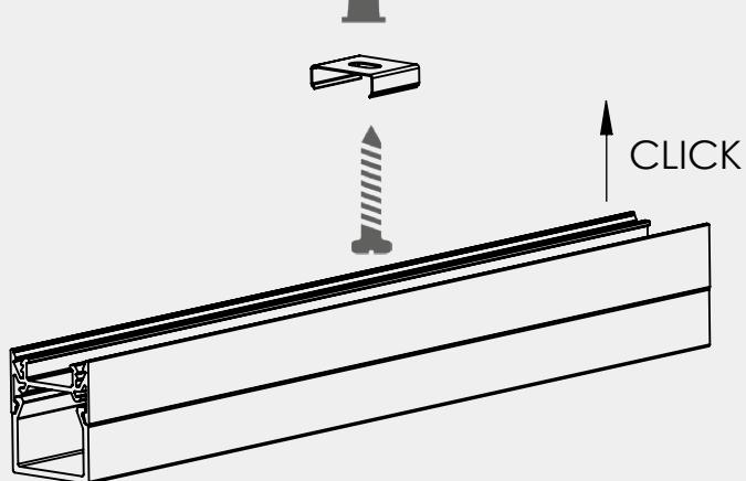
Bei Montage der Klammer sicherstellen, dass diese sich noch etwas drehen lässt, ansonsten kann es zu Knackgeräuschen führen bei Wärmeausdehnung.
