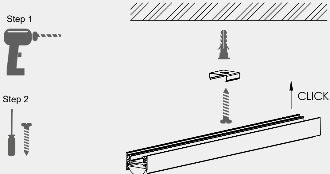
Bei Montage der Klammer sicherstellen, dass diese sich noch etwas drehen lässt, ansonsten kann es zu Knackgeräuschen führen bei Wärmeausdehnung.
