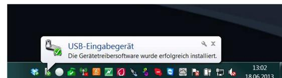
Aufgrund des in Windows integrierten built-in-Supports für HID-Geräte besteht keine Notwendigkeit einer Treiberinstallation, da Windows das DALI USB automatisch erkennt und die notwendigen Treiber installiert.
