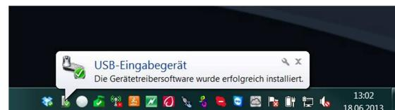
Aufgrund des in Windows integrierten built-in-Supports für HID-Geräte besteht keine Notwendigkeit einer Treiberinstallation, da Windows das DALI USB automatisch erkennt und die notwendigen Treiber installiert.
