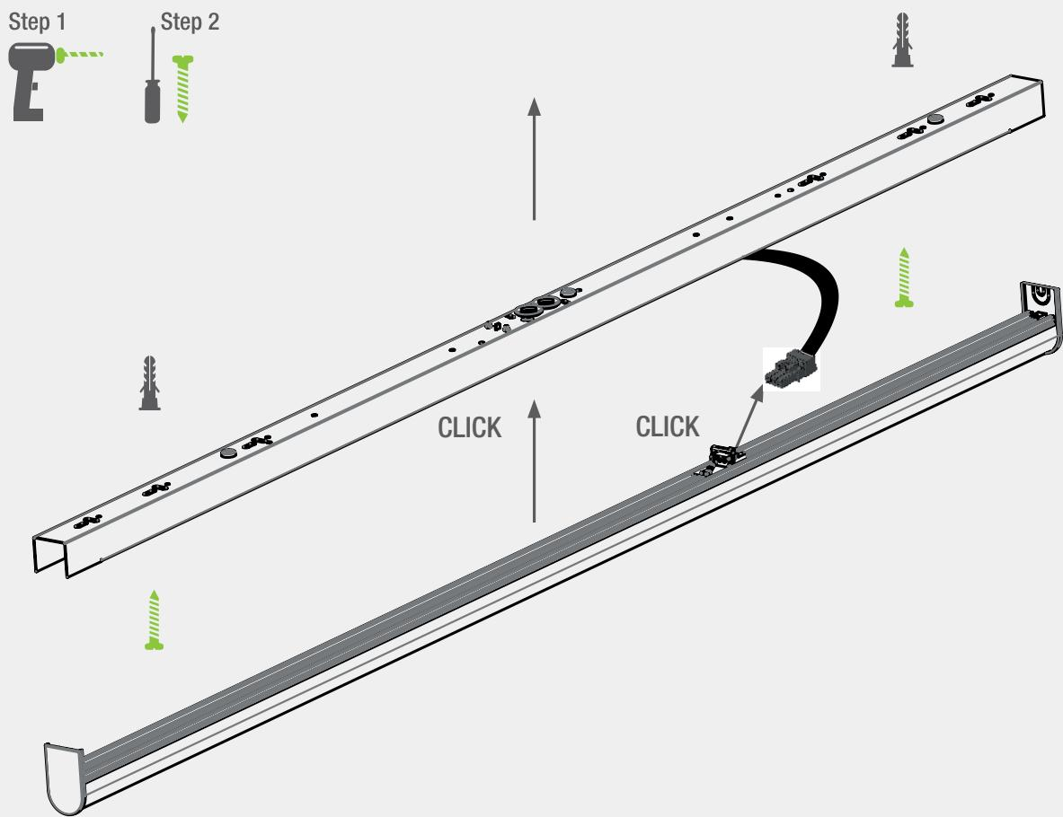
Il connettore tra le due componenti dell'apparecchio non può essere collegato se sotto tensione!
