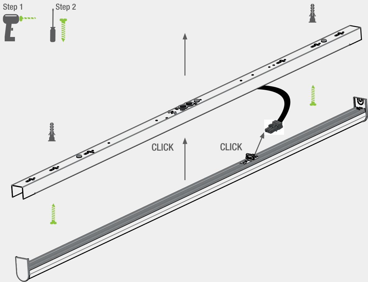
La fiche de connexion entre les deux parties du luminaire ne doit pas être raccordée sous tension !
