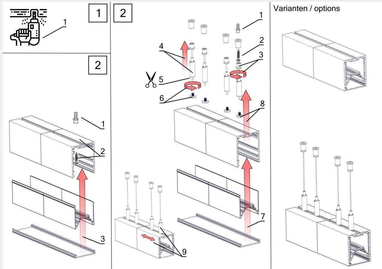
Il canale esterno deve essere obbligatoriamente dotato di messa a terra! In caso di smontaggio tramite cacciavite, abbassare i profili interni dagli appositi fori.
